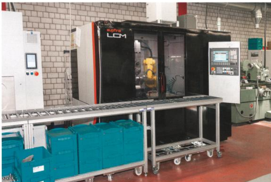
1 Supfina LCM TS zur Oberflächen-Feinstbearbeitung, bei Hirschmann im Einsatz bei Fahrwerkskomponenten
