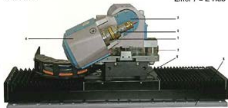
Bild 4: Ziffer 1 = \mu -PrisFix Span- ner; Ziffer 2 = Kundenspezi- fische Palette inkl. Werkstück- aufnahme; Ziffer 3 = Schwenk- achse; Ziffer 4 = Rotationsachse; Ziffer 5 = Linea- rachse 1; Ziffer 6 = Linearachse 2; Ziffer 7 = Z-Hub
