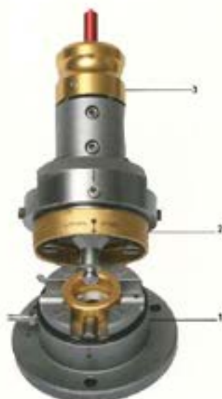
Bild 3: Das Nullpunkt-Spannsystem » \mu -PrisFix nano« erzielt bei der Kleinteilebearbeitung eine Wiederholgenauigkeit von \leq 0,1 \mu\text{m} und eine Wechselgenauigkeit von \leq 0,5 \mu\text{m} . Ziffer 1 = \mu -PrisFix nano Spanner, Ziffer 2 = Carl Hirschmann Palette/Werkstückträger. Ziffer 3 = Kundenspezifische Werkstückaufnahme, ausgelegt für den automatischen und manuellen Werkstückwechsel
