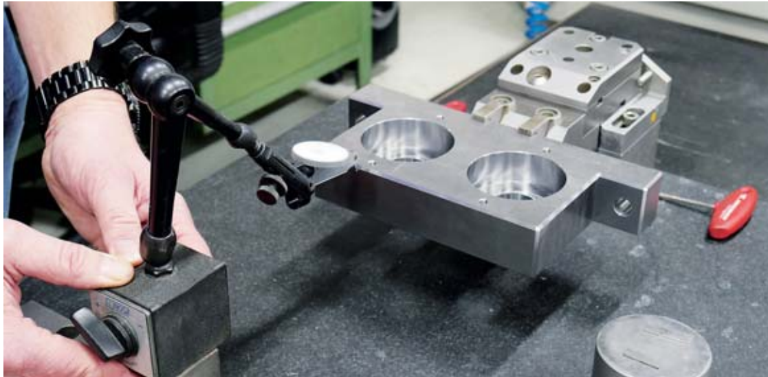
Mit dem Spannsystem 5000 ist die präzise, prozesssichere und durchgängige Herstellung der unterschiedlichsten Elektroden auf den automatisierten HSC-Fräsmaschinen gewährleistet.
