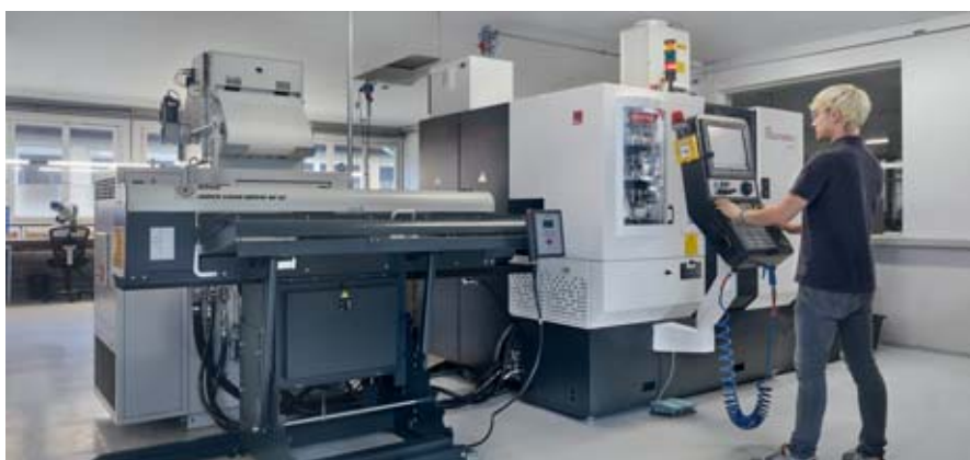
Ein Jahr lang erlernten Peter Tschida, seine Söhne Florian (im Bild) und Maximilian, wie sich mit dem Sieben-Achsen-Bearbeitungszentrum Bumotec s191 medizinische Instrumente µm-genau herstellen lassen.
