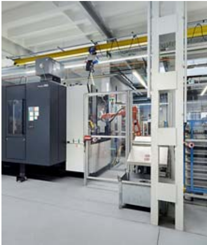
Die Stahlwille-Gesenschmiede schätzt die Präzision und Wiederholgenauigkeit des Bearbeitungszentrums Heckert H55. Bild: Starrag/Ralf Baumgarten Seite 40
